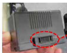
（図4）バッテリー接続口
