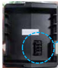
(図4) バッテリー接続口
