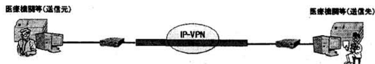
図 B-2-3-a 単一の通信事業者が提供する閉域ネットワークで接続されている場合
